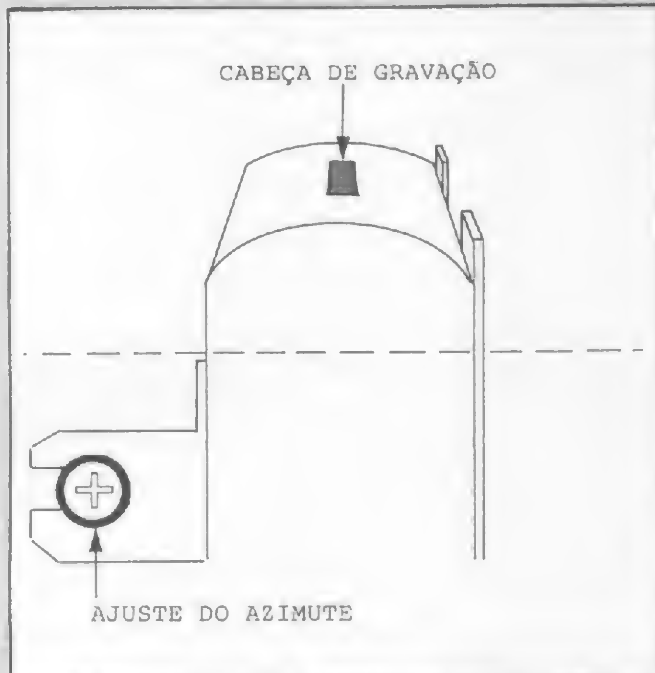
Figura 1 - Cabeça de gravador cassete vista de cima
